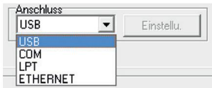
5. Klicken Sie im Register „Drucker Konfiguration“ im Abschnitt „Drucker Funktion“ auf die „Netzeinstellungen“-Schaltfläche. Hier können Sie IP-Adresse, Subnetzmaske und Gateway des integrierten Netzwerkadapters einstellen.
