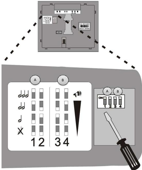
Sowohl der Ton, als auch die Lautstärke davon können mittels den 4 Schaltern auf der Rückseite des Displays eingestellt werden.
