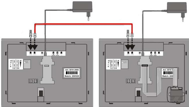
In der oberen Skizze sieht man, wie mehrere Displays mittels Datenkabel miteinander verbunden werden. Es ist zu beachten, dass unbenutzte Daten Ein- und Ausgänge mit den mitgelieferten Steckern verschlossen werden (siehe Skizze oben). Die obere Skizze bezieht sich auf eine Erweiterung die weiter hinten im Kapitel "Möglichkeit der Erweiterung" erklärt wird.
