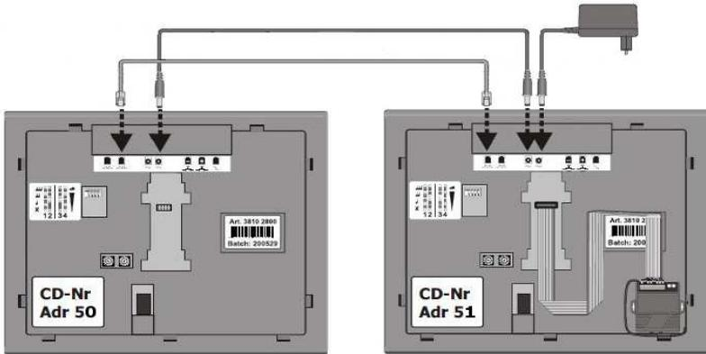
Diese Möglichkeit ermöglicht Ihnen, dass ein zweites Display (Adresse 50) genau das selbe anzeigt wie der Master (Adresse 51) der von der Fernbedienung gesteuert wird. Hierfür müssen Sie lediglich die zweiten Display, wie oben graphisch dargestellt, mit dem aktuellen verbinden und ihm die Adresse 50 geben.
