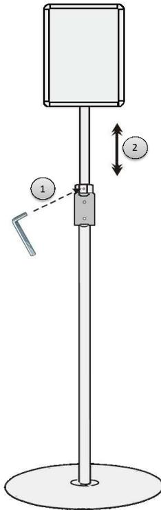
1) Um die Höhe des Rahmens und somit des oberen Teleskoprohres zu verstellen lösen Sie zuerst die oberste Schraube in der Verbindungsmanschette, bis das obere Rohr beweglich ist. (ACHTUNG! Sobald die Schraube gelöst ist, rutscht das obere Rohr in das untere hinein. Gefahr durch einklemmen! -> Festhalten!)
