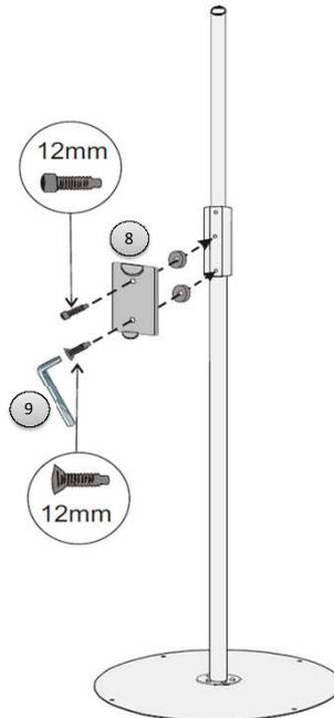
8) Schrauben Sie die Halterung für den Ticketspender bei den unteren zwei Löchern in der Verbindungsmanschette fest. Hierfür legen Sie bitte die mitgelieferten schwarzen Distanzscheiben zwischen Halterung und Manschette.
