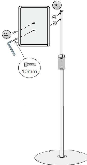
10) Legen Sie die weißen Distanzstücke mit der Runden Seite auf das obere Teleskoprohr und fixieren Sie den DIN A3 aluminium Klapprahmen mit den beigelegten Schrauben
